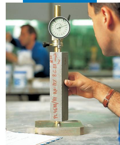
Определение расширения в стесненных условиях согласно норме UNI 8147/80
