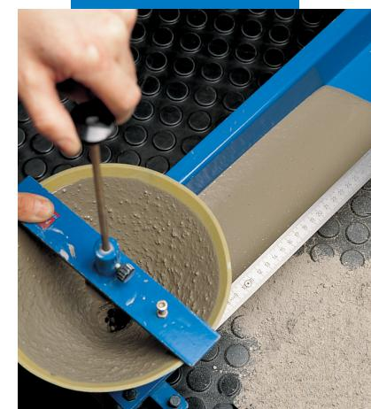
Испытание расширения в канавке согласно норме UNI 8997/89
